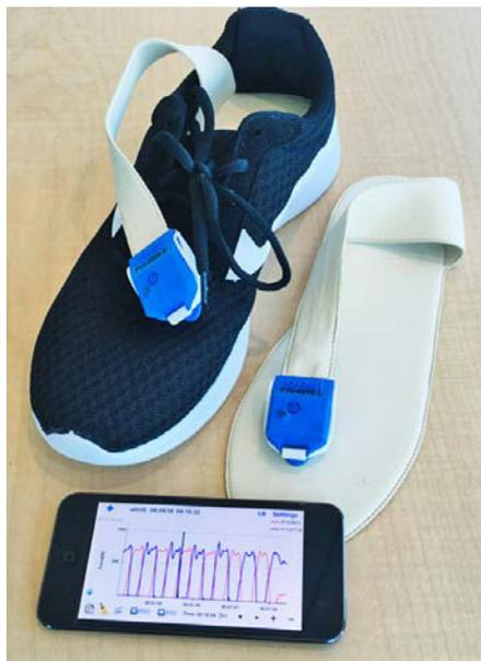
**Abb. 2:** Loadsol® in einem Sportschuh, wie sie im klinischen Alltag verwendet wird. Der iPod touch dient als Bedienkonsole, um die Messung aufzuzeichnen
