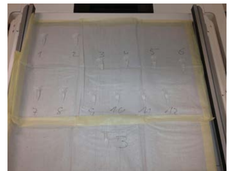
Abb. 7: Aufsicht auf den Gammakameradetektor mit aufliegenden 2,5 ml-Tubes
