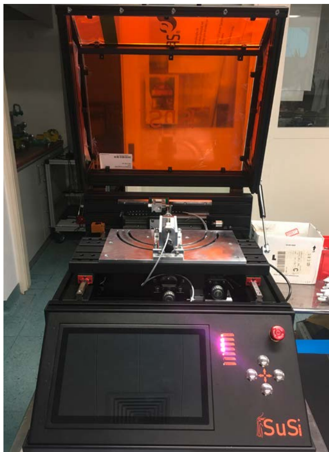
Abb. 4: Der Schulter Simulator wurde im LBI für Experimentelle und Klinische Traumatologie entwickelt und konstruiert (Michael Aufreiter) und dient der Testung unterschiedlicher Therapiemodalitäten bei Schulterpathologien
