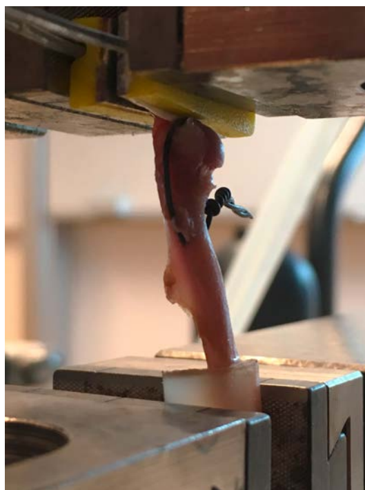
Abb. 1: Biomechanische Testung nach RM-Naht an der Ratte (adaptiert aus Feichtinger et al.: AJSM 2019) 1
