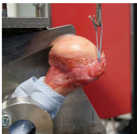
Abb. 1: Aufbau für die biomechanische Testung der Fadenankersysteme aus dem Tuberculum majus. Der Humeruskopf ist in einem 135°-Winkel in axialer Zugrichtung fixiert
