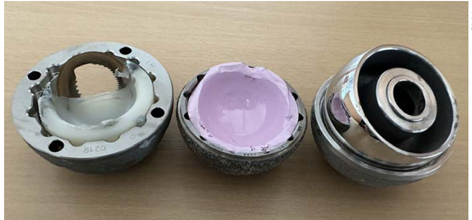
Abb. 2: Abriebinduzierte Dezentrierung mit konsekutiven Osteolysen (links), Keramikbruch (hier aufgrund eines Anwenderfehlers, Mitte) oder Revisionspflichtigkeit aufgrund der Freisetzung von Metallpartikeln/Ionen (rechts) sind zwar in der Revisionschirurgie noch relevant, sollten jedoch bei den aktuell verwendeten Materialien eine Seltenheit darstellen
