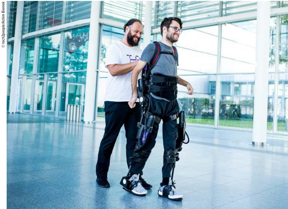
**Abb. 1:** Exoskeletale Gangtherapie für Menschen mit Schwächungen oder Lähmungen der unteren Extremität
